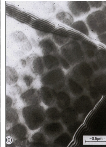
Précipités \text{Ni}_3\text{Al} (10-100 nm)
